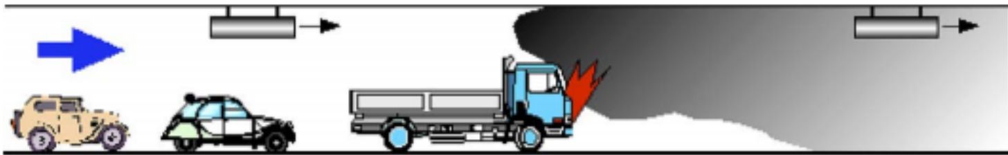
Figure 1: Contrôle longitudinal de la fumée d'incendie (Vauquelin, 2008).
